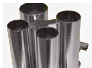
Tramoggia per verdure lunghe in acciaio inox (opzionale)
